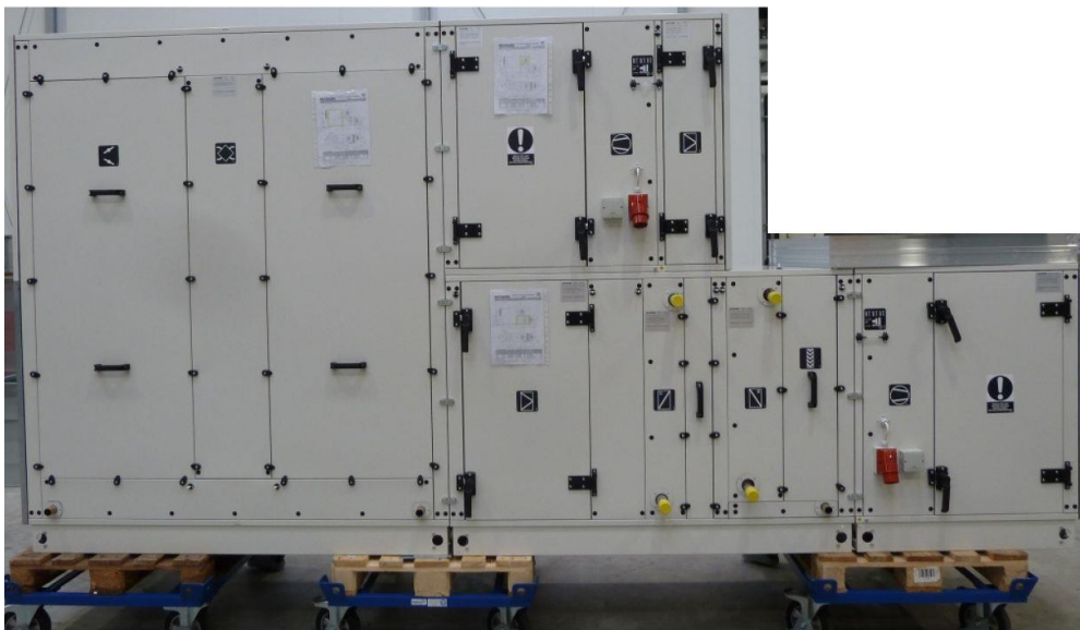
Figure 4. La centrale réelle – les mesures des propriétés mécaniques des enveloppes et des paramètres de performance en laboratoire
