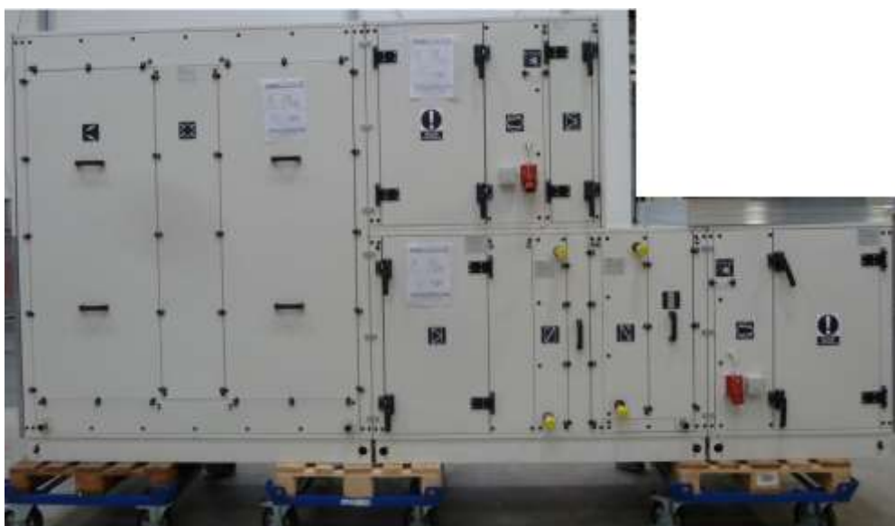
Obr. 4. Reálná jednotka – měření mechanických vlastností opláštění a výkonových parametrů v laboratoři
