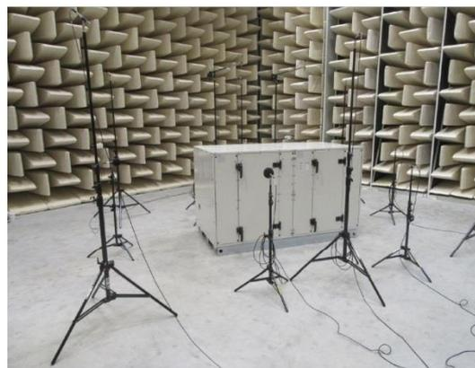
Рис. 1. Опытный образец – тестируемый образец    Рис. 2. Опытный образец – акустическая камера
