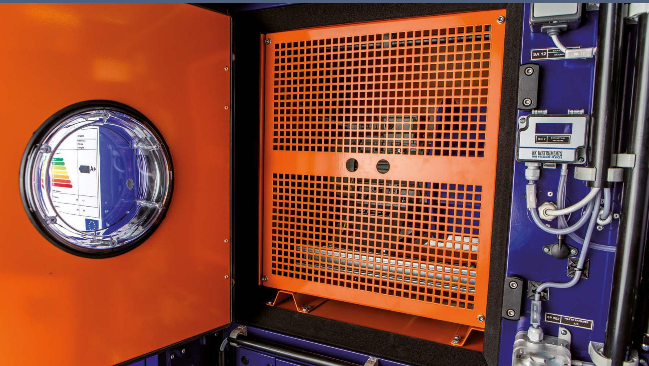
» M3.15 Деталь камеры вентилятора с защитной решеткой
