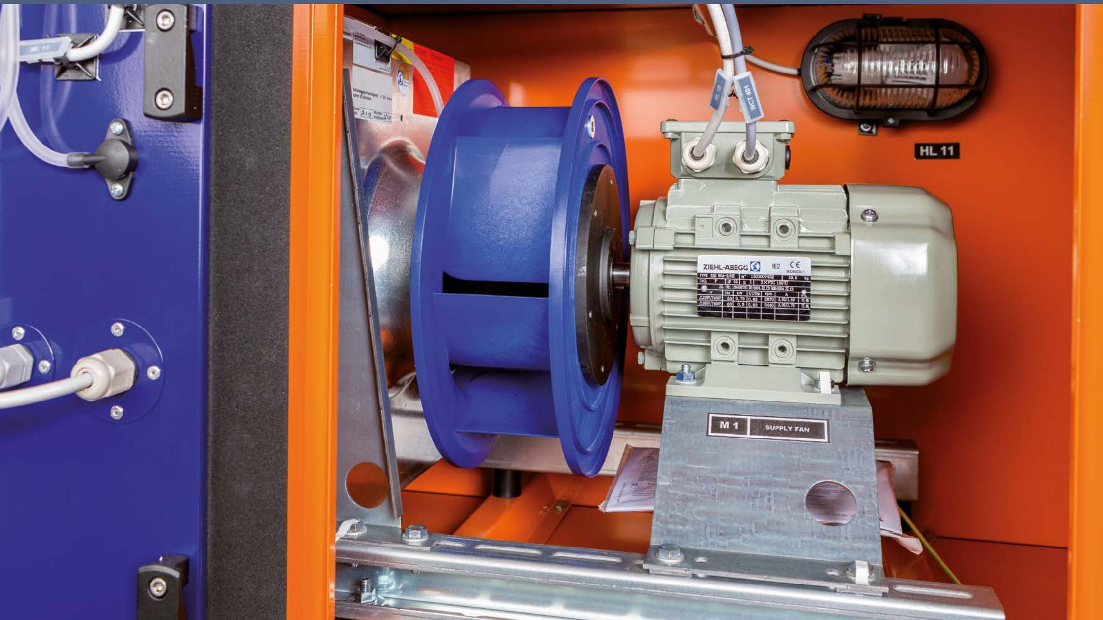
» M3.15 Деталь вентилятора с кабелями и LED освещением
