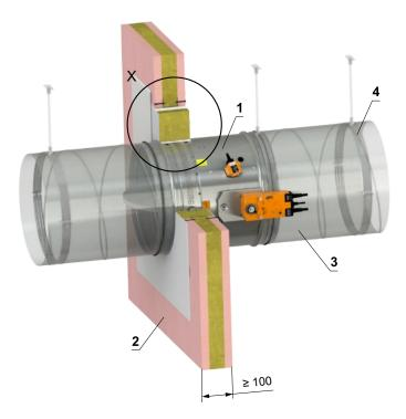
\*\* Pour la résistance au feu El 45 S, l'espace entre la structure et le clapet doit être compris entre 30...75 mm.
