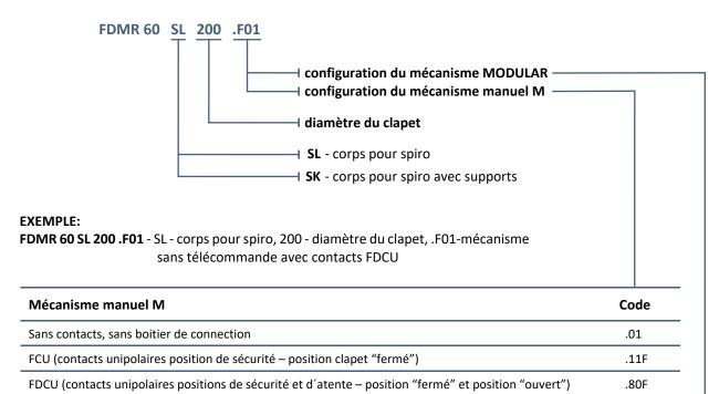
**Attention:** Codes .11 et .80 correspondent à des configurations sans boitier de connexion mais avec contact de position FCU ou FDCU, avec un ou deux câbles de raccordement, respectivement. Dans ce cas, le produit n'est pas conforme aux normes NF S 61937-1 et NF S 61937-5.
