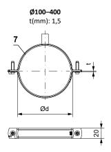
Ø100-400 Système de fermeture rapide 2x vis M6×20. Écrou de fixation pour tige filetée M8.
