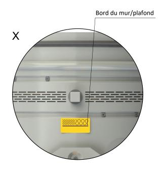
L'étiquette "BUILT IN EDGE" indique le bord recommandé de la construction coupe-feu (mur/plafond). Le clapet doit être installé de manière à ce que l'ensemble du clapet (en position fermée) se trouve dans la construction coupe-feu (mur/plafond) et qu'en même temps le mécanisme et les ouvertures d'inspection soient librement accessibles.
