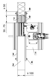
\* Le système HILTI peut être remplacé par un système similaire avec une épaisseur, une densité et une classe de réaction au feu identiques ou supérieures, testé selon la norme EN 1366-3.
