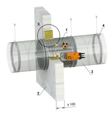
\*\* Pour la résistance au feu EI 45 S, l'espace entre la structure et le clapet doit être compris entre 30...75 mm.
