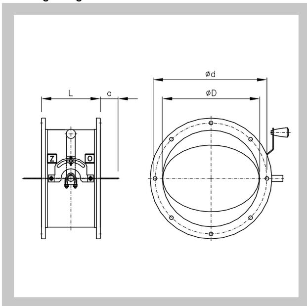
La fig. 4 Registre avec commande par motorisée
