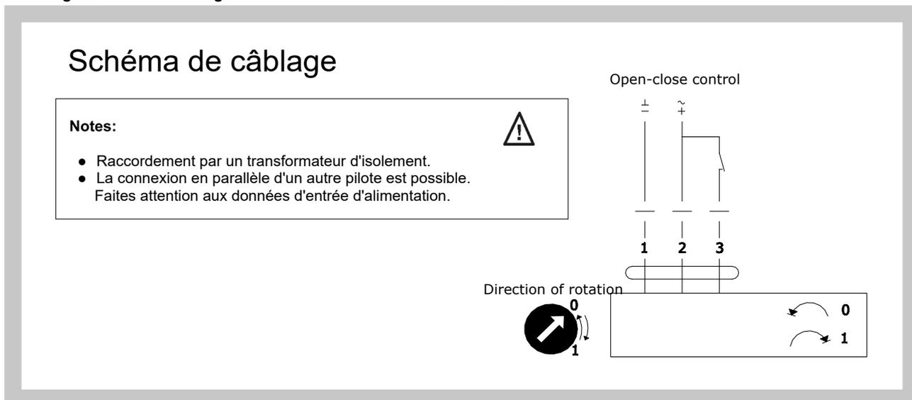
Fig. 10 Schéma de câblage des servo-moteurs Belimo NM 24A-S et SM 24A-S
