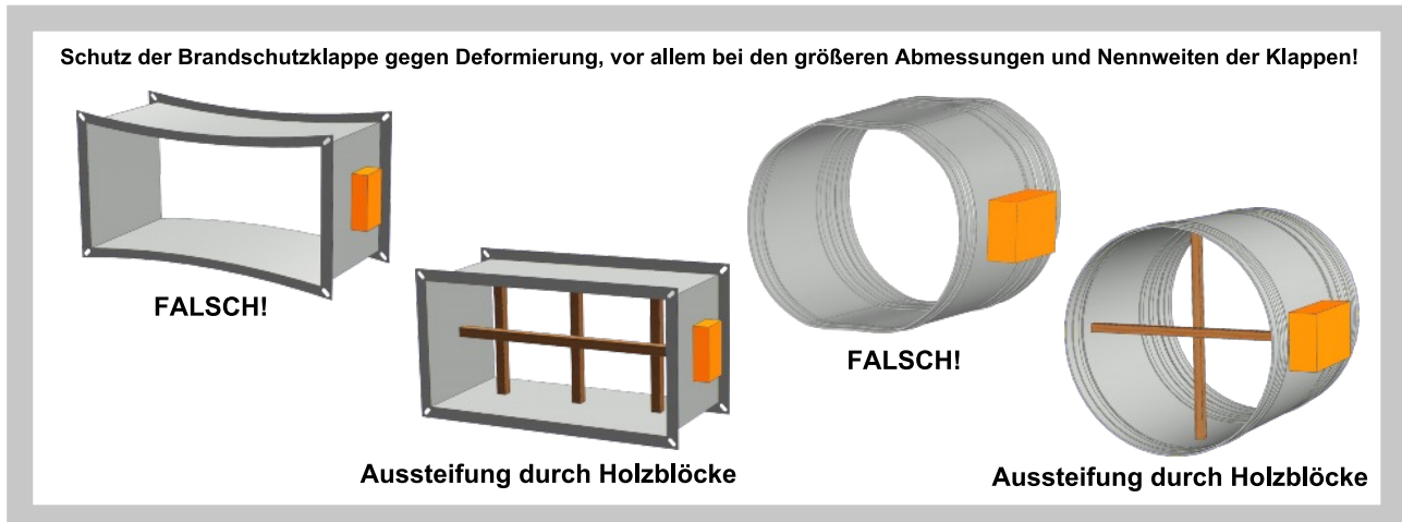
Abb. 117 Einbau/ Aussteifung der Brandschutzklappe
