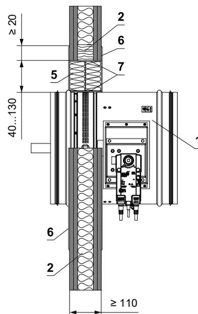
\* Le système HILTI peut être remplacé par un système similaire avec une épaisseur, une densité et une classe de réaction au feu identiques ou supérieures, testé selon la norme EN 1366-3.
