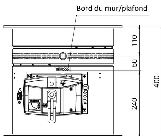
Dimensions d'une ouverture d'installation
