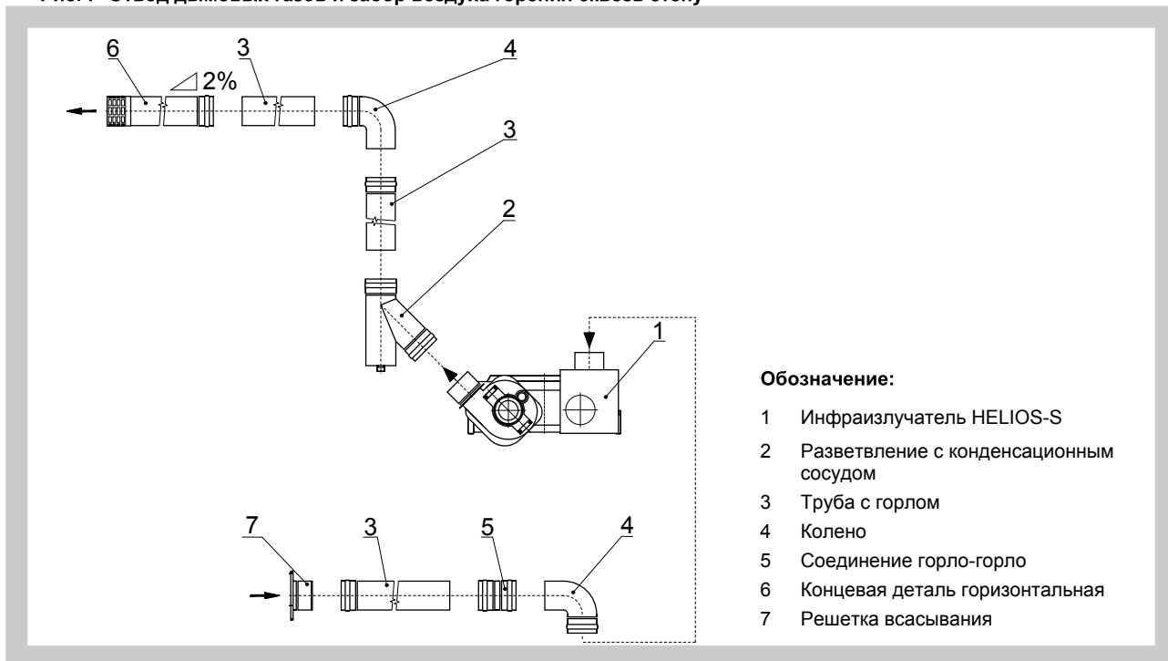
Рис. 8 Отвод дымовых газов и забор воздуха горения коаксиальной трубой сквозь крышу
