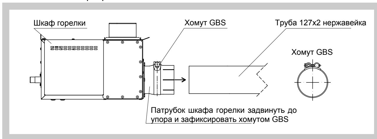
Рис. 20 Установка шкафа горелки
