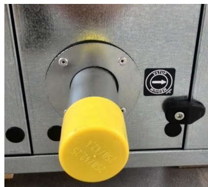
Označení výstupu do výměníku
